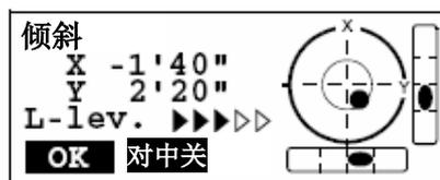
4. 使用脚螺旋调整三脚架上的仪器位置至使对中激光点对准测点标志中心。
